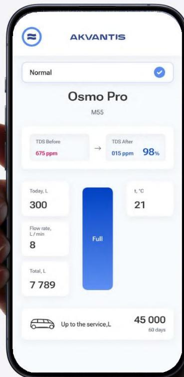
Grazie all'applicazione mobile, il proprietario del sistema può monitorare in tempo reale la qualità dell'acqua in ingresso e dell'acqua purificata, mentre il team di assistenza può diagnosticare da remoto il funzionamento dell'apparecchiatura e pianificare interventi di manutenzione tempestivi.
